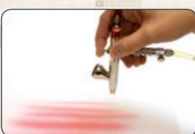
**Breite Linie/Verlauf:** Hebel in der Bewegung weiter nach hinten ziehen, zügig bewegen. Am Ende das Gerät absetzen und in Gegenrichtung sprühen.
