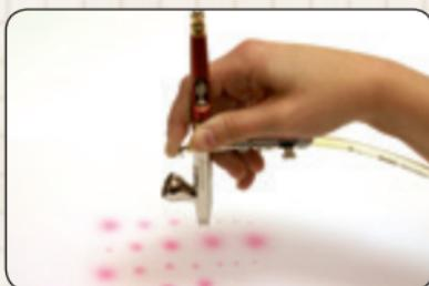
**Línea ancha / dispersa:** Durante el movimiento tirar la palanca aún más hacia atrás moviendo el aparato continuamente. Al final, depositar el aparato y pulverizar en dirección opuesta.
