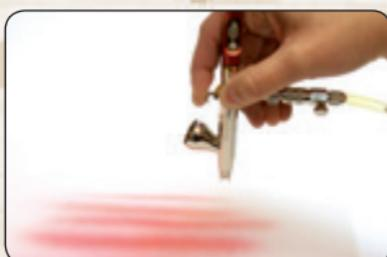
**Línea fina:** Empezar con aire, tirar la palanca hacia atrás solamente durante el movimiento para evitar "puntos". Al final, volver a poner la palanca hacia delante, a continuación, soltarla totalmente.
