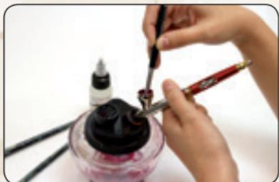
**Tussentijdse reiniging:** de verf opgebruiken, de resten met water en/of een geschikt reinigingsmiddel en een penseel of wattenstaafje oplossen en verstuiwen.
