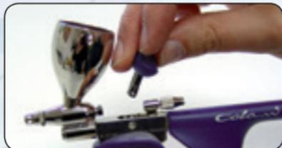
**Ändra spaken för vänsterhanta:** Skruva bort nålfästmuttern (K), dra ut nålen (I). Lossa avkännarskruvarna (H) med universalsnyckeln (V). Ta bort spaken (F), vrid den 180° och vrid fingerkulans avplattade sida framåt. Sätt i spaken (F) och skruva in avkännarskruvarna (H).
