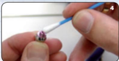
**4.** De luchtkop (B) losschroeven en reinigen.
