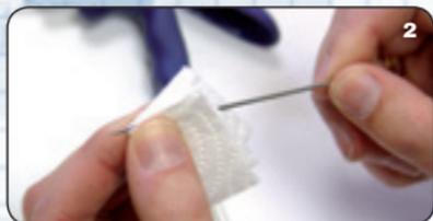
**2.** Nadel (I) herausziehen, mit einem Tuch und Reiniger säubern. Nadelspitze auf Deformierung überprüfen.
