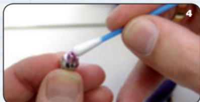
**4.** Luftkopf (B) abschrauben und reinigen.
