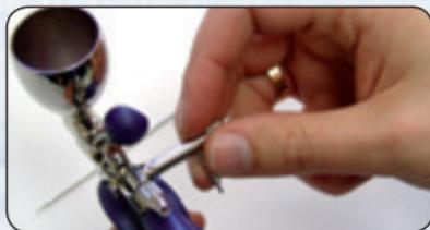
**Posizionamento della leva per mancini:** svitare il dado di serraggio dell'ago (K), sfilare l'ago (I). Svitare le viti del tasto (H) utilizzando la chiave universale (V). Asportare la vite (F), ruotare a 180° e girare la parte piatta della pallina della leva in avanti. Inserire la leva (F) e avvitare le viti del tasto (H).
