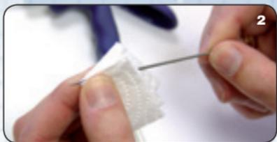
**2.** De naald (I) uittrekken en met een doek en reinigingsmiddel reinigen. De naaldpunt op vervorming controleren.
