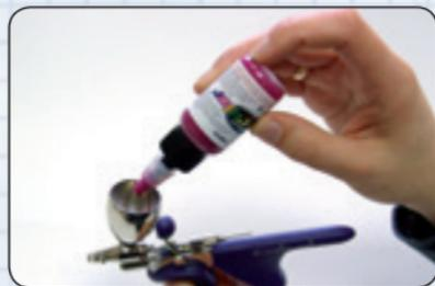
Si possono utilizzare tutti i colori o vernici per aerografia aventi una consistenza simile al latte, il colore va poi diluito a seconda dei casi. Prima di effettuare il rifornimento di colore il serbatoio fornito in dotazione (D) va avvitato allo strumento.
