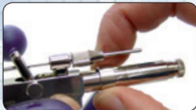
**Inserimento degli anelli distanziatori (U) per prolungare lo strumento:** sfilare l'estremità (N). Aggiungere uno o due anelli distanziatori (U) nella parte posteriore dello strumento e spingerli in avanti fino ad arresto. Riporre l'estremità (N).
