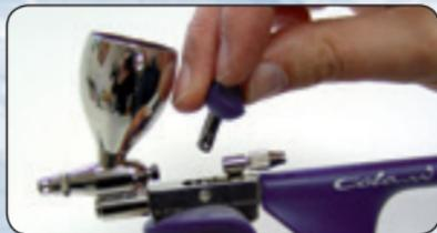
**Cambio de posición de la palanca de manejo para zurdos:** Desenroscar la tuerca de apriete de la aguja (K), extraer la aguja (I). Soltar los tornillos palpadores (H) con la llave universal (V). Retirar la palanca (F), girar en 180° y girar hacia delante el lado aplanado de la bola para el dedo. Insertar la palanca (F) y enroscar los tornillos palpadores (H).
