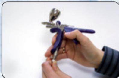
Sluit het apparaat met een schroeffitting\* of snelkoppeling NW 2,7 mm\* aan op een slang\* en een geschikte persluchtbron\*.
