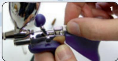
**Grondige reiniging (vóór langere periodes van niet-gebruik): 1.** De persluchttoevoer uitschakelen. De naaldklemmer (K) losschroeven.
