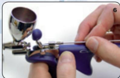
**6.** Inserire e avvitare l'ugello (C) nel puntale dell'ugello (B). Riavvitare il puntale dell'ago (A). Inserire cautamente l'ago (I) fino ad arresto. Riavvitare il dado di serraggio dell'ago (K).
