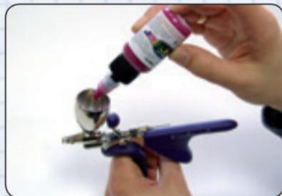
Es sind alle gängigen Airbrush-Farben oder Lacke geeignet, die eine milchähnliche Konsistenz haben. Die Farbe ist ggf. entsprechend zu verdünnen. Vor dem Einfüllen der Farbe ist der im Lieferumfang enthaltene Becher (D) auf das Gerät aufzuschrauben.
